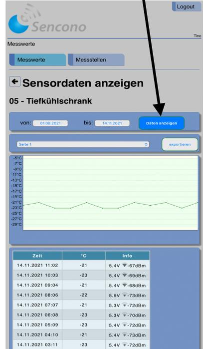
Angezeigt wird der Temperaturverlauf im definierten Zeitraum. Der dunkle Bereich markiert die Schwellenwerte. Abweichungen werden als roter Punkt dargestellt.
